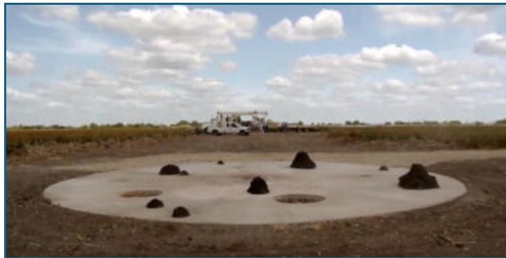
Level 2 Landeplatz mit simuliertem Mondboden mit Kratern und Hügeln
