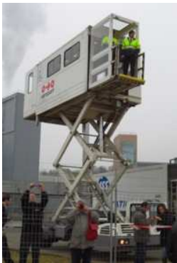
Es braucht auch spezielle Fahrzeuge, um z.B. das Catering oder gehbehinderte Passagiere in das obere Deck zu laden.
